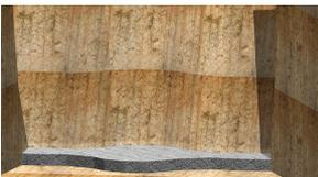
El pozo debe apoyar sobre una losa de hormigón de calidad H-100 o similar y de espesor mínimo 20cm.
