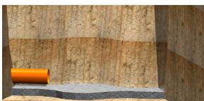
Antes de colocar el pozo sobre la losa se verterá hormigón fresco con el objetivo de que la base del pozo quede totalmente embebida, de forma que no queden huecos ni cavidades entre la base del pozo y el hormigón que la envuelve.
